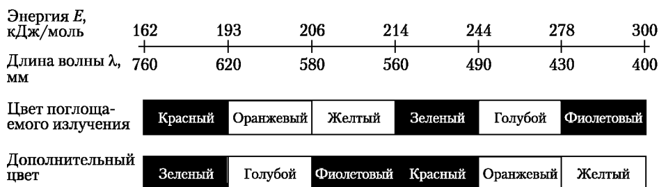
Рис. 13.8. Диаграмма соотношений между цветом поглощаемой части спектра, цветом отраженной части спектра (дополнительным цветом), длинами волн и энергией 1 моль квантов света
